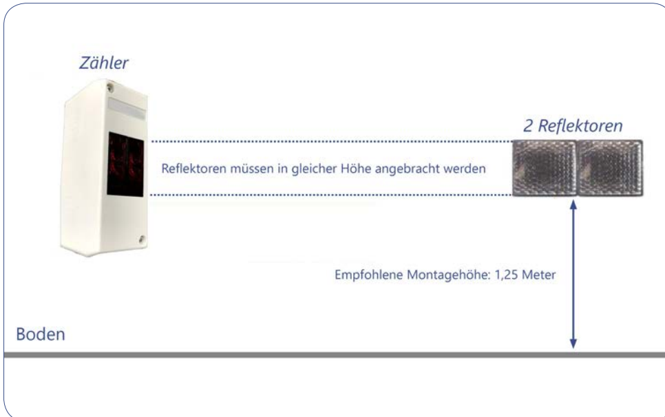
Anbringung des Zählers und der Reflektoren
